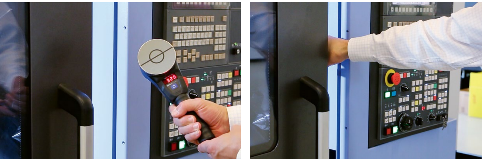
Misurazione di verifica delle impostazioni della forza
